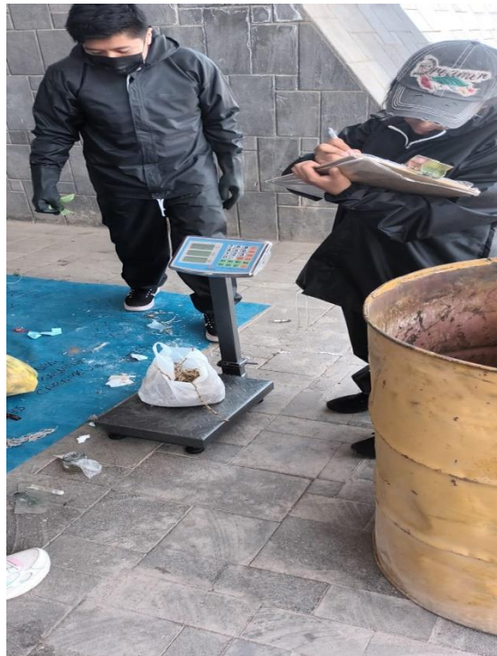
Registro del peso de las muestras para hallar la generación per cápita
